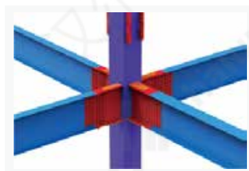
模块化装配式钢结构系统
